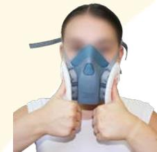
Placer les pouces sur la partie centrale des filtres, inhaler doucement : le masque doit s'affaisser légèrement.
