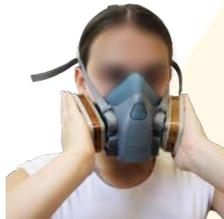
Placer la paume des mains sur les cartouches, inhaler doucement : le masque doit s'affaisser légèrement. Si des fuites d'air surviennent le replacer et ajuster les sangles.
