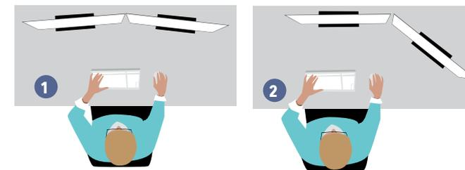
1. Si les deux écrans sont utilisés tout au long de la journée avec un temps de travail identique, ils doivent être positionnés face à l'utilisateur. La jointure des écrans doit se trouver face à l'utilisateur et former un léger angle.
